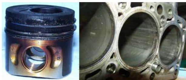
Slika 1. Karbonizacija ulja na klipnu motora i mehanički oštećen blok motora
