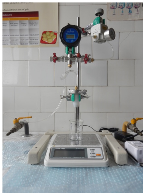
Slika 1. Aparatura za membransko emulgovanje, sa redukcionim ventilom i magnetnim mešačem.
