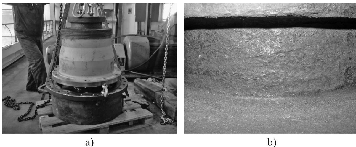
Slika 3. Reduktor pužne preše a) makro izgled; b) oštećene zaptivne i dosjedne površine kućišta Figure 3. Screw press gearbox
