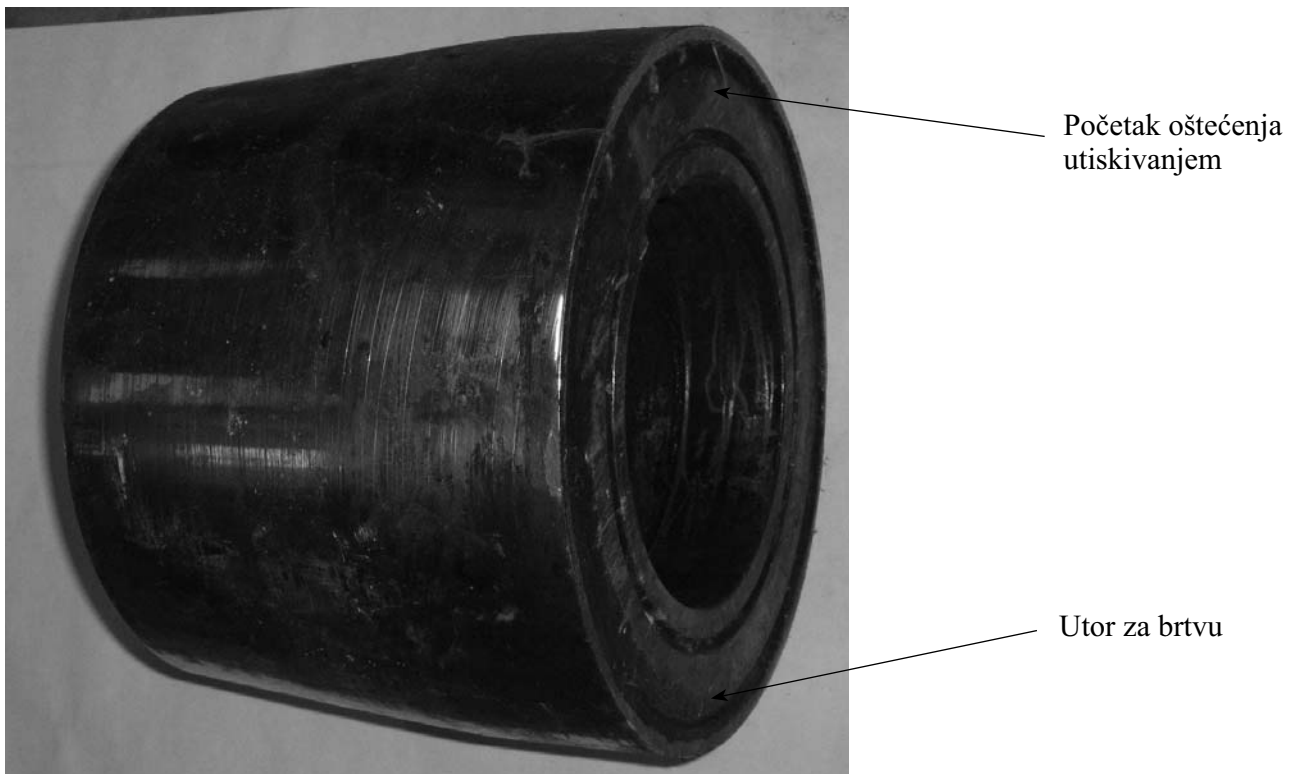
Slika 5. Konusni segment u začetku oštećenja Figure 5. Cone segment - beginning of damage
